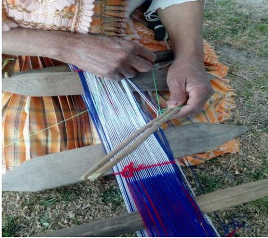
Imagen 55. Colocación del primer *kisi* -o par de bastones, lizo o disyuntador- en medio de la urdimbre (Fotografía de la autora).
