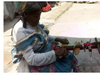
Imagen 30. Textilera utilizando la herramienta *Xant'a* –primera o más delgada- para separar los hilos dentro del tejido en la urdimbre (Fotografía de la autora).
